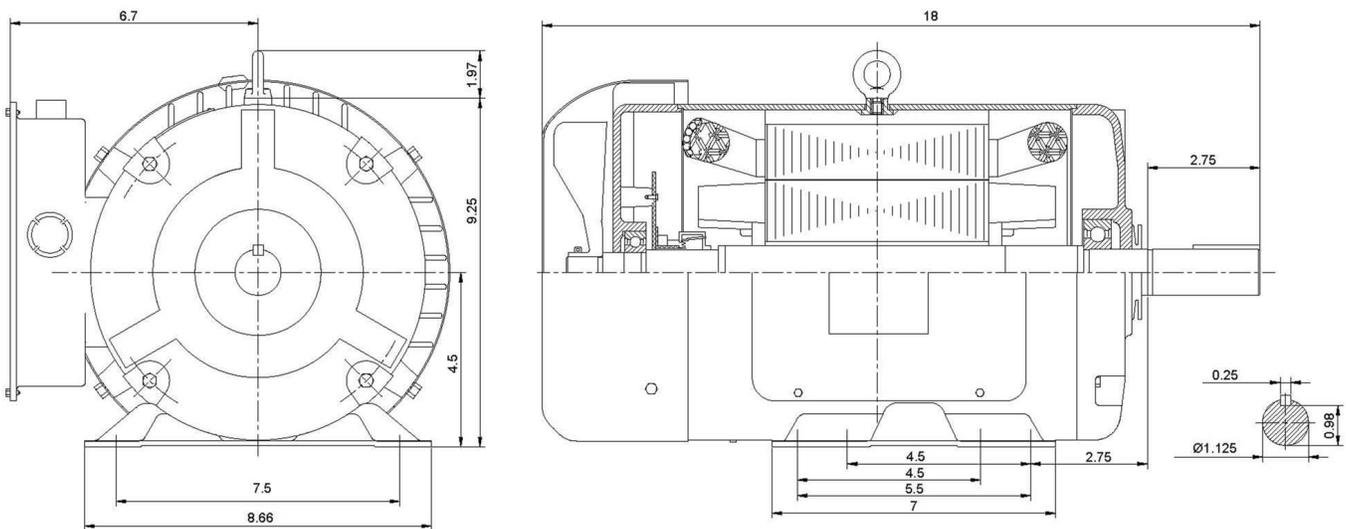
El plano general del motor permite identificar de manera clara las proporciones y referencias de montaje necesarias para su correcta instalación. Al incluir las vistas principales —frontal, lateral se asegura una representación completa del equipo desde diferentes ángulos, lo que facilita la interpretación por parte de diseñadores, instaladores y personal de mantenimiento.
